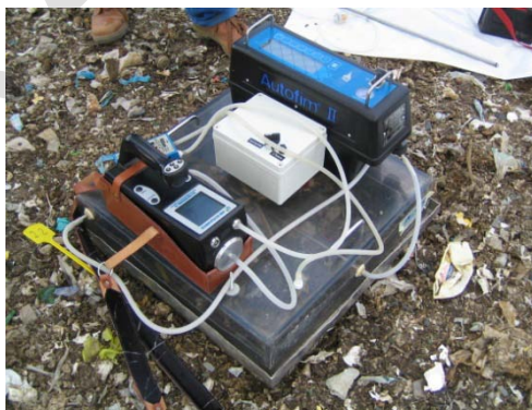
Figure 7 : Dispositif de chambre à recirculation en acquisition continue par FID (Telegon), PID et IR (Ecoprobe) pour le suivi en continu des émissions de COV, CH 4 , CO 2 et COVT
