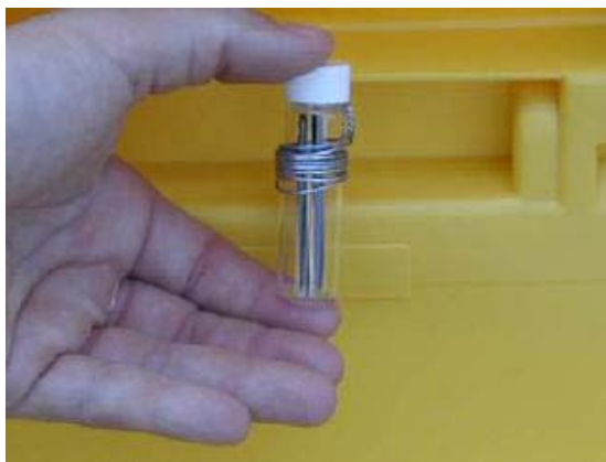
Vial contenant le préleveur passif, d'après Beacon Environmental Services, Inc,
