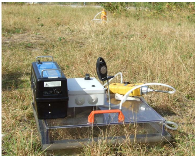
Figure 24 : Dispositif de chambre à accumulation et recirculation externe couplé à un PID RAE et un FID (Telegan).
